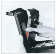
D. 前板をいっぱいに開けます。フイルムバックの両側を持ち、遮光カバーの印刷面(フイルム面)を外側に向けて、先端をガイドにつきあて矢印方向に押し込みます。
