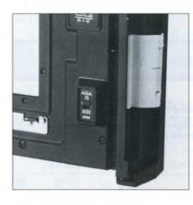
ポラロイドバックSには、ASA/ISO切換スイッチがあります。 4頁 のフイルムの種類にしたがって、あらかじめ ASA/ISO 感度を75または3000にセットしておきますと、露出計内蔵ファインダーと自動的に連動します。
