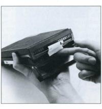
A. 遮光カバーを引き抜いてしまっても白タブが出ないときは、直射日光を避けて、日陰か室内で、裏蓋をわずかに開け、フイルムパックを動かさずに、白タブの端を外側に出します。
