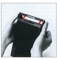
C. ロックレバーの両端を矢印の方向に動かし、裏蓋を開きます。フイルムを入れる前に、必ず引蓋を完全に挿入しておいてください。
