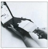
B. フイルムパックが浮き上がらないように、指先で押えて裏蓋を開き、いちばん上の黄タブを写真のように引き抜いてください。
