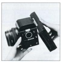
A.カメラからフイルムバックをはずし(SQ-Aカメラ使用説明書8頁、SQ-Amカメラ使用説明書口頁「フイルムバックの着脱」の項参照)カメラボデイ上部の取りつけ穴にポラロイドバックSの上部金具をさし込み、下部をカメラボデイに押しつけます。
