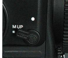
Für optimale Bildergebnisse ist eine verwacklungsfreie Auslösung unumgänglich. Um alle unnötigen Kameraerschütterungen während der Belichtung auszuschließen, besitzt die 645E eine Spiegelvorauslösung.
