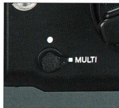
Durch Umschalten auf die Mehrfachbelichtung können auf einem Filmbild beliebig viele Aufnahmen gemacht werden. Wenn die Mehrfachbelichtung aktiviert ist, kuppelt der Filmtransport aus; mit dem Transporthebel wird in diesem Fall nur der Verschluss für die nächste Aufnahme gespannt.
